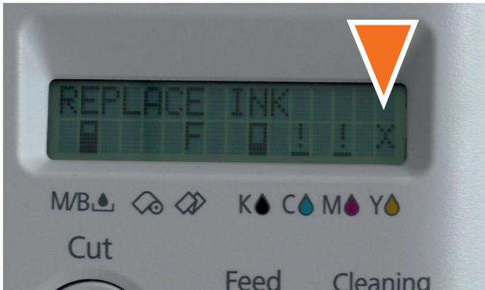
Mit Leermeldung einer Tintenpatrone stellt der Drucker die Arbeit ein und fordert zum Austausch dieser Patrone auf. Auf dem Display am Drucker wird für die betroffene Farbe ein Kreuz statt des Tintenfüllstandes angezeigt. Spätestens jetzt ist der Reset des Tintenchips an der Patrone notwendig.
